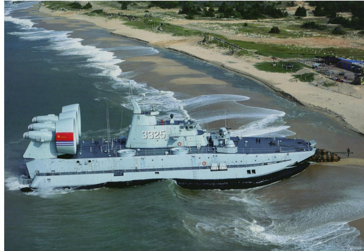
Hydroglisseur avec une vitesse de 50 nœuds permettant de débarquer 500 hommes et huit véhicules blindés. Ce type d'engin a été conçu par la marine soviétique, repris par l'Ukraine, et dispose d'une autonomie de 500 km.
