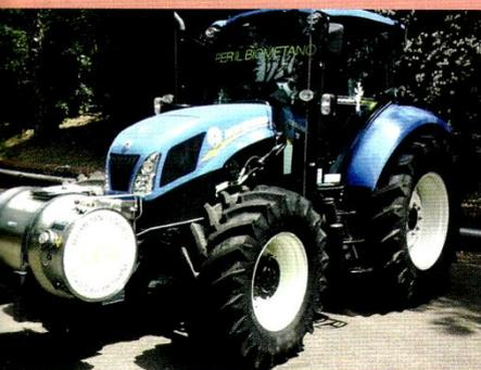
**Photo ci-dessus :** Tracteur fonctionnant au biométhane liquide. (© S. Furfari)
